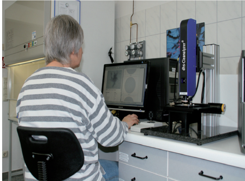
Der vollautomatisch arbeitende dhs-Cleanalyzer steht in verschiedenen Ausführungen zur Verfügung und ermöglicht je nach Modell die Detektion von Partikeln im Größenbereich bis 5 µm.
