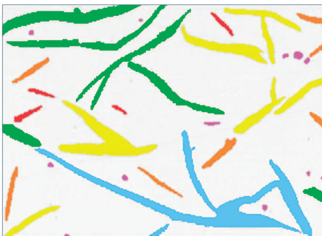
Bild 4. Mit bisherigen Verfahren erfolgt keine Trennung miteinander verbundener Lamellen. Im Bild ist die untere, hellblaue Struktur ein zusammenhängendes Objekt. Die Lamellengröße ergibt sich aus dem Durchmesser des Umkreises um ein solches Objekt.
