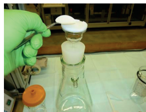
Filter in Filtrationseinheit einbringen
