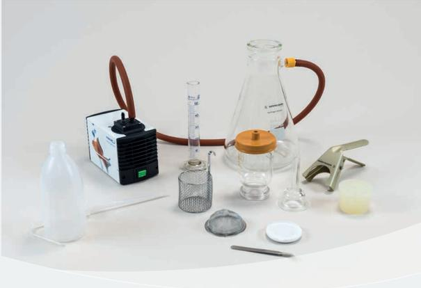
Grundausrüstung zur Reinigung und Extraktion von Bauteilen nach VDA Bd.19. Optional werden Ultraschallwannen und Trocknungsgerät angeboten, je nach Bauteilgröße. Gerne beraten wir Sie individuell!
