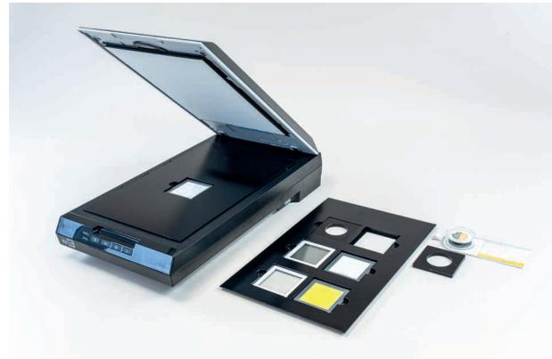
Der Einsatz der Aluplatte bietet optimierten Abstand zwischen Diarahmen und Abtast-Einheit des Scanners und somit eine verbesserte Bildschärfe (Sichtbarkeit der Partikel-Konturen).
