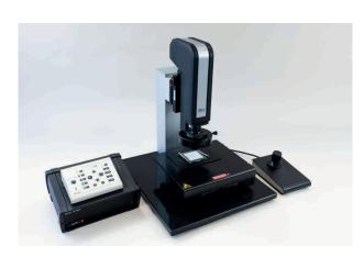
Der dhs-Cleanalyzer® ist für die Auswertung unterschiedlicher Filtermaterialien, -formen und Partikelfallen konzipert.
